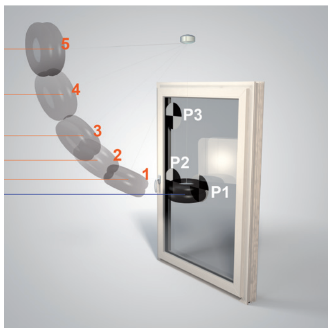
Points d'impact P1 centre du panneau P2 point central du bord le plus long P3 angle du panneau
