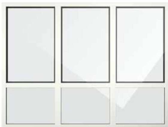
zesdelige raamwand met drie profielloze vleugels bovenaan en drie velden vaste beglazing onderaan
