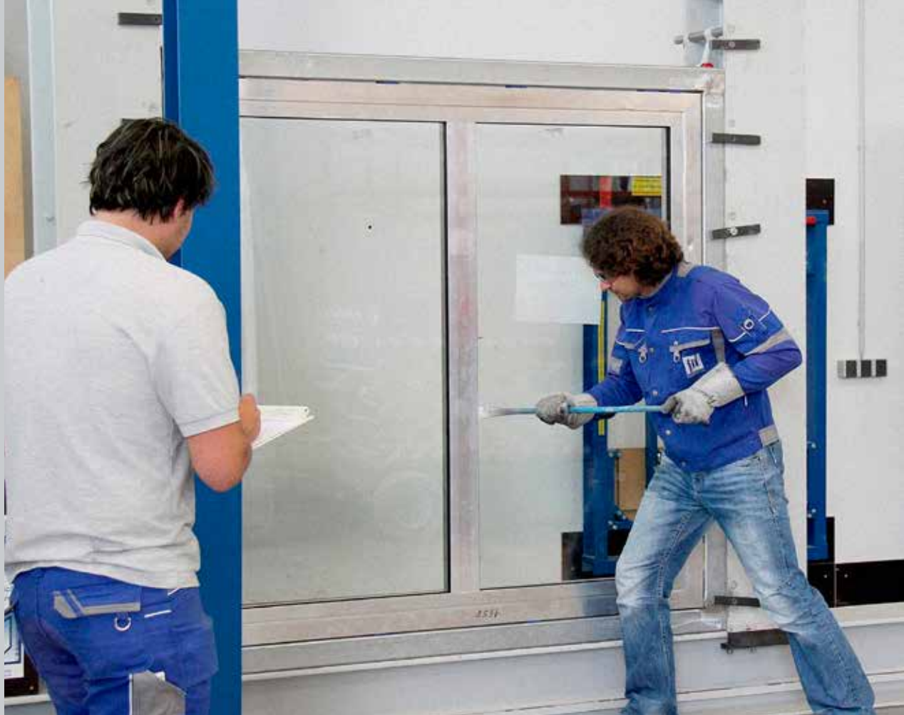
Aan de testopstelling onderzoekt het Institut für Fenstertechnik (ift) Rosenheim de inbraakwerendheid van ramen.
