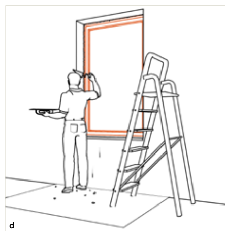
De dagkant wordt van buiten en van binnen hersteld (pleisteren en schilderen). Indien nodig wordt een steiger gebruikt.
