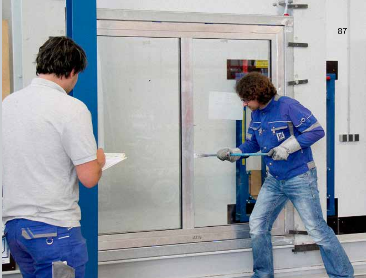
En el banco de pruebas, el Instituto ift de Rosenheim comprueba la resistencia antirrobo de las ventanas.
