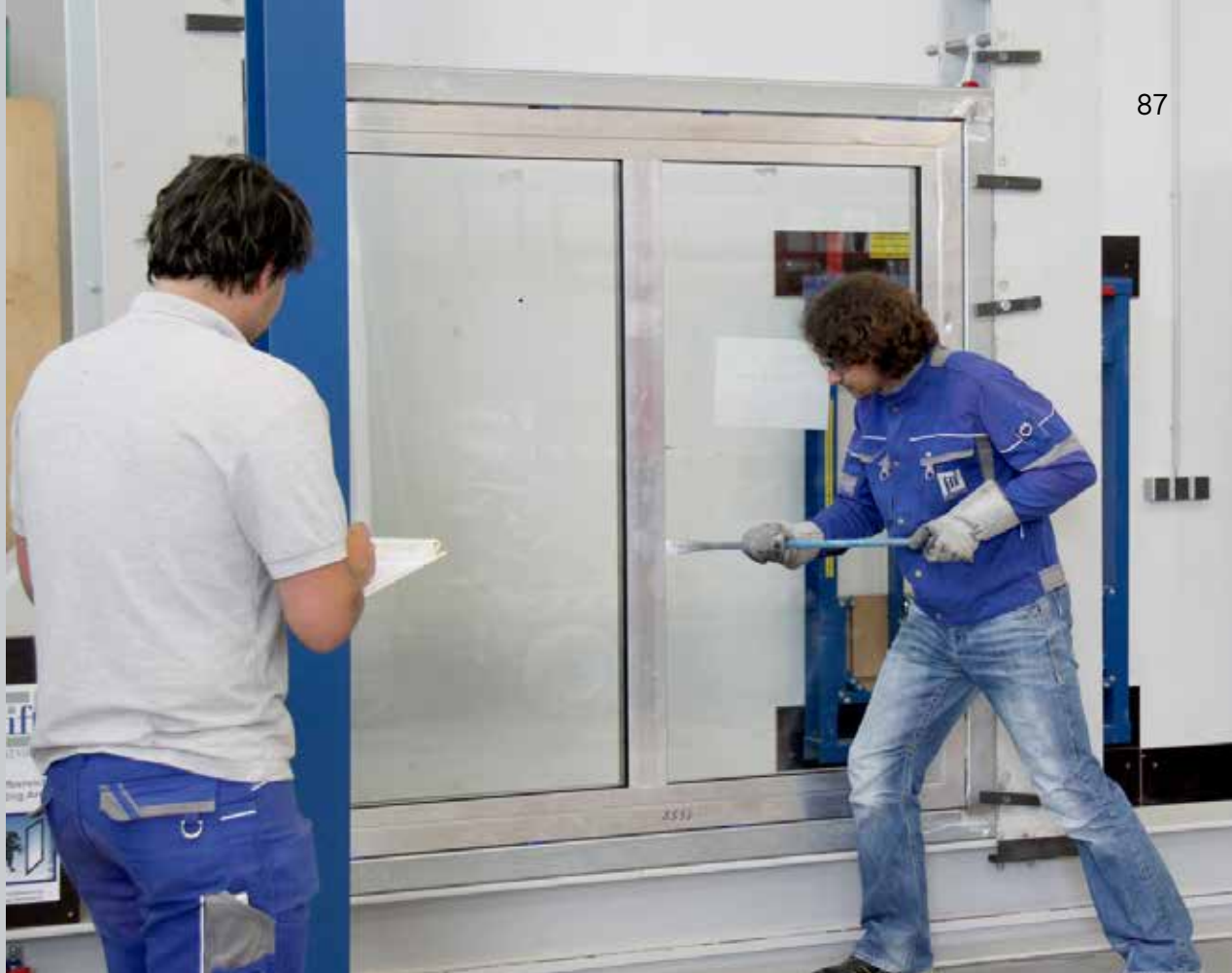
Al banco di prova l'Istituto ift di Rosenheim verifica la sicurezza antieffrazione delle finestre.
