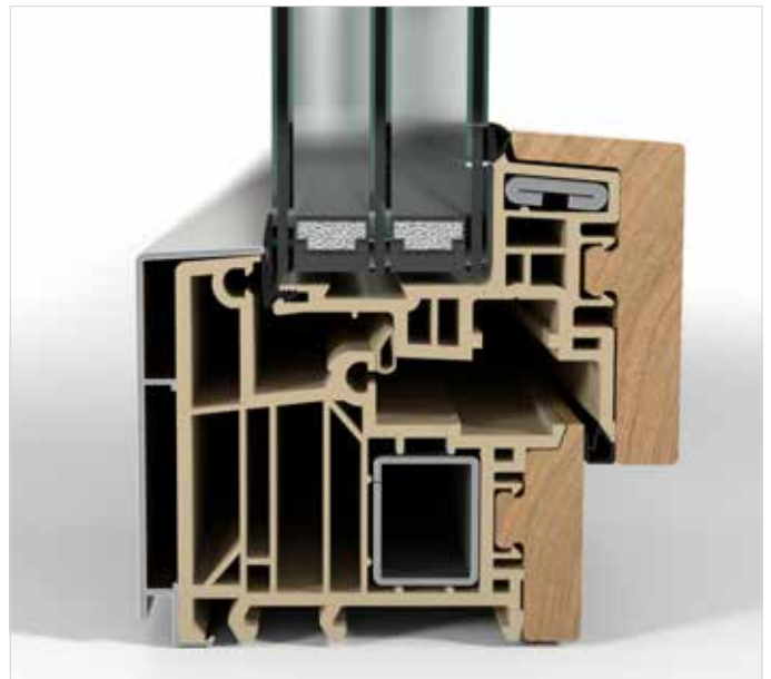
Sezione di un profilo in alluminio-legno Finstral: FIN-Window Nova-line 77+8 alluminio-legno
